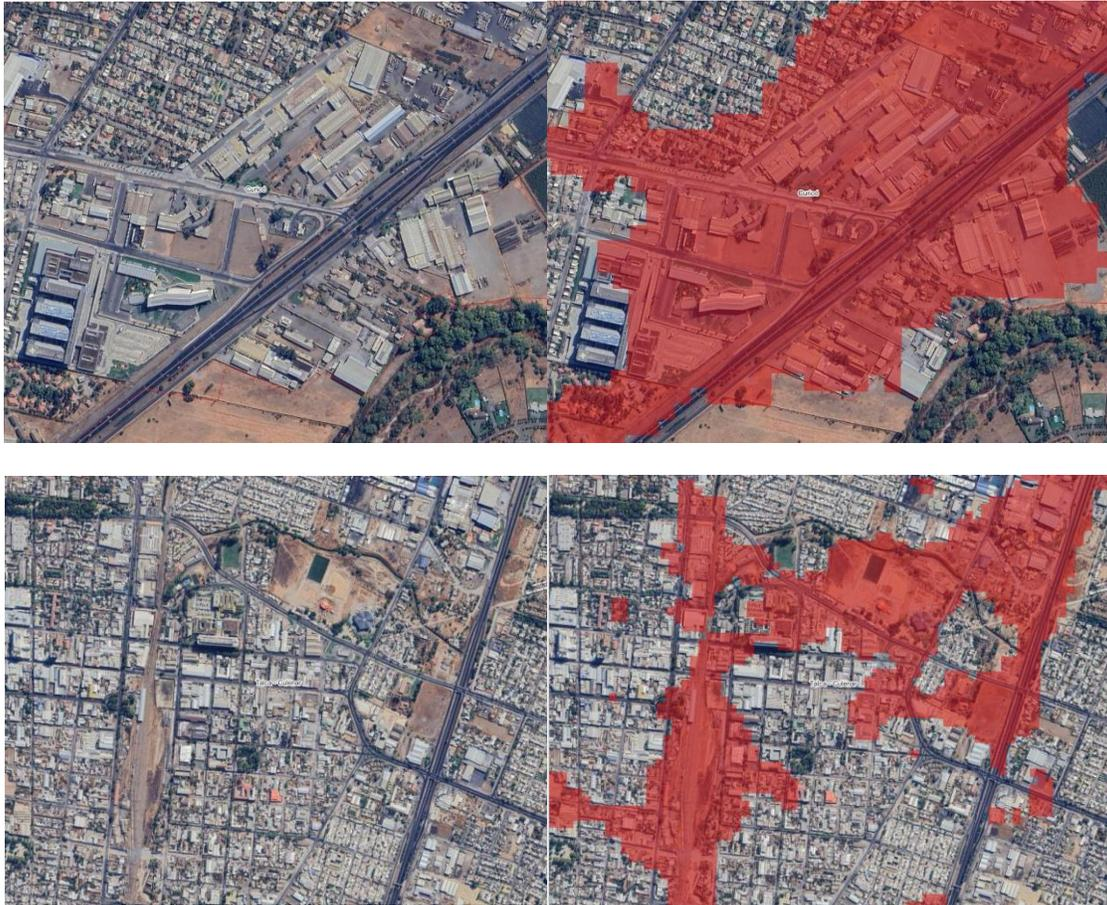
Figura 15. Arriba: detalle de Curicó, las zonas con presencia de superficies metálicas. Abajo: detalle de Talca-Culenaar, zonas con suelos desnudos Fuente: Elaboración propia. Datos Landsat 9
